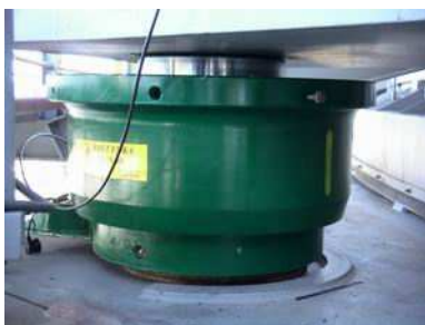
Rys. 1. Schemat układu hydraulicznego wyważania zwalówarek [7] (oraz fotografie siłowników układu wyważania)
