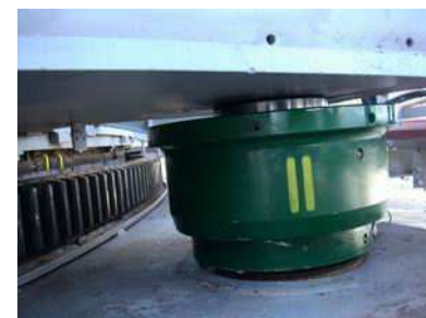
Rys. 1. Schemat układu hydraulicznego wyważania zwalówarek [7] (oraz fotografie siłowników układu wyważania)
